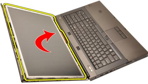
7. 剥下胶带, 并断开低压差分信号 (LVDS) 电缆与显示屏面板背面的连接。
