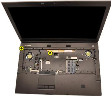
12. 断开扬声器电缆的连接。
