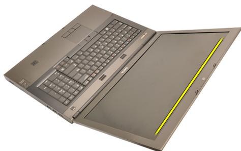
4. 沿着显示屏挡板的底部边缘和侧面操作，然后卸下显示屏挡板。
