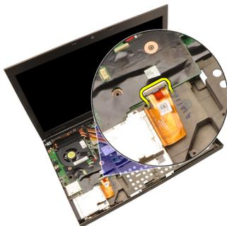
11. 拧下用于将 Input/Output (IO) 板固定到位的螺钉。
