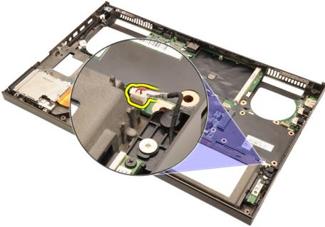
24. 断开 DC-in 电缆的连接。
