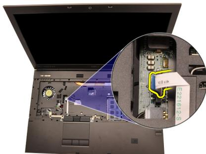
15. 断开无线射频 (RFID) 电缆的连接。
