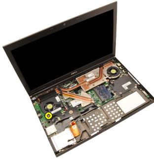
12. 向上提起 IO 板的右边缘，脱离连接器，并从计算机卸下。
