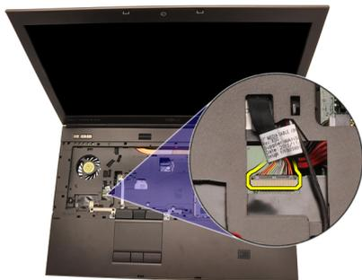
14. 断开触摸板电缆的连接。
