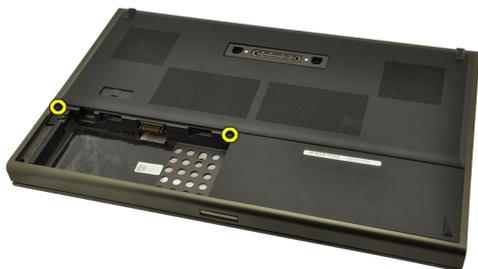
4. 朝计算机后部按橡胶脚垫，以脱离底盖。
