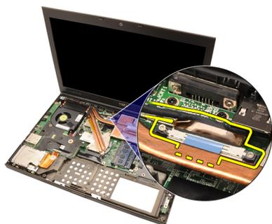
17. 断开摄像头电缆的连接。
