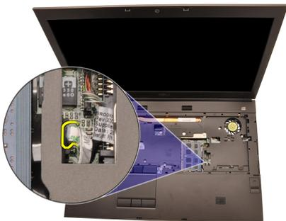
17. 断开 Bluetooth 电缆的连接。
