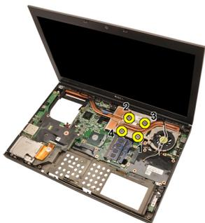
18. 向上提起图形卡散热器，并从计算机卸下。
