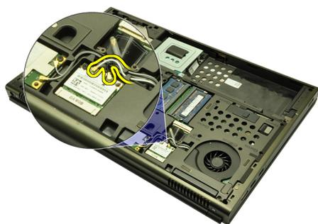
5. 拧下用于将 WLAN 卡固定到计算机的螺钉。
