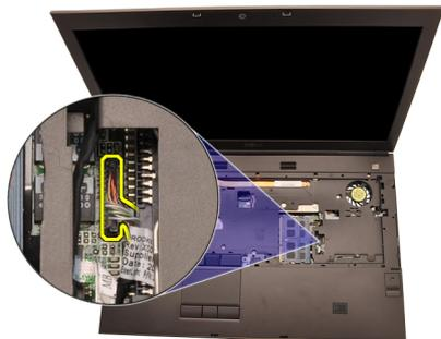
18. 断开电源按钮电缆的连接。
