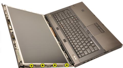
5. 拧下右侧将显示屏面板固定到位的螺钉。
