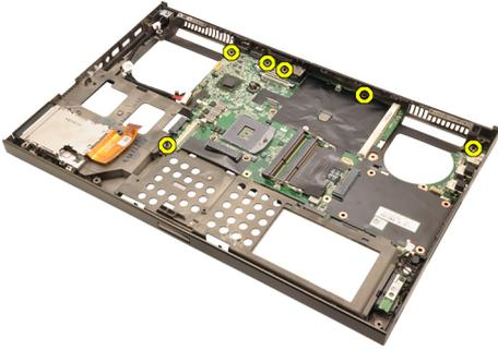
26. 将系统板部件的底部边缘轻轻提起，并提起到 45 度角。
