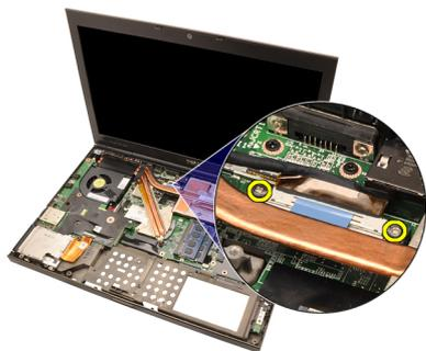
16. 断开 LVDS 电缆的连接。
