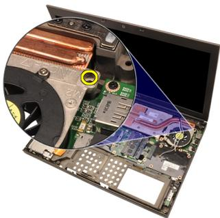
17. 拧松散热器上的固定螺钉 (1 > 2 > 3 > 4)。
