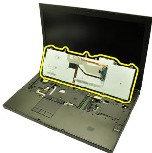
8. 剥下用于将键盘数据电缆固定到键盘背面的胶带。
