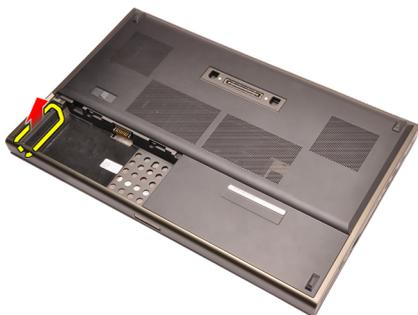
4. 断开 Bluetooth 电缆与 Bluetooth 卡的连接。
