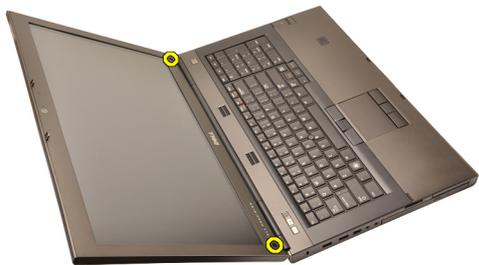
4. 拧下用于将显示屏挡板固定到位的螺钉。
