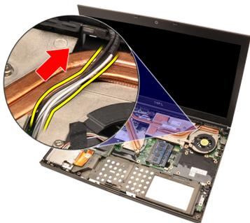
15. 拧松用于将低压差分信号 (LVDS) 固定到位的固定螺钉。
