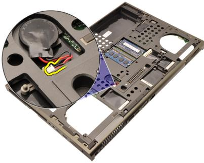
23. 断开系统板顶端无线开关电缆的连接。
