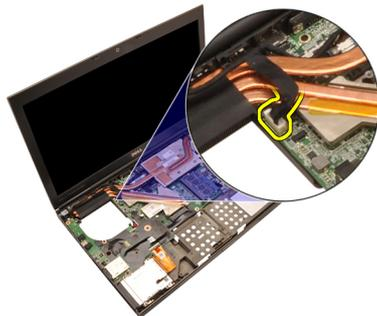
12. 拧松散热器上的固定螺钉 (1 > 2 > 3)。
