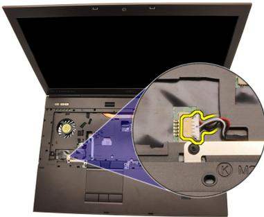
13. 断开介质板电缆的连接。
