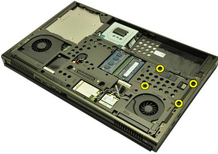
5. 拧下用于将硬盘驱动器门锁固定到位的螺钉。
