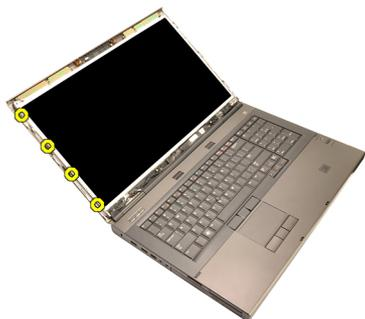
5. 拧下用于将显示屏面板固定到位的螺钉。
