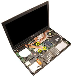
13. 向上提起 CPU 散热器并从计算机卸下。
