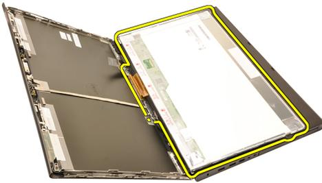
11. 拧下用于将显示屏支架固定到显示屏面板的螺钉。
